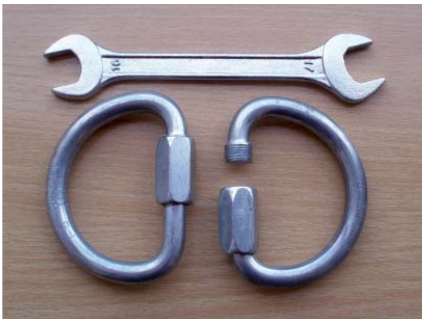
Obr. 5.26 Karabina typu Q
