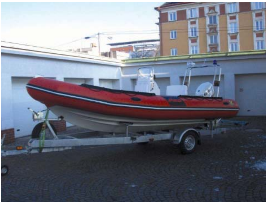
Obr. 6.19 Plavidlo smíšené konstrukce s laminátovým dnem
