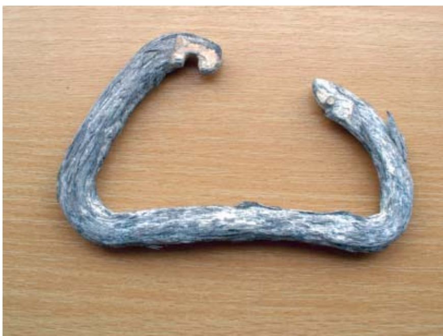
Obr. 5.12 Karabina poškozená korozí
