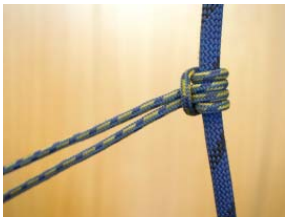
Obr. 5.24 Vytvoření posuvného svíracího uzlu
