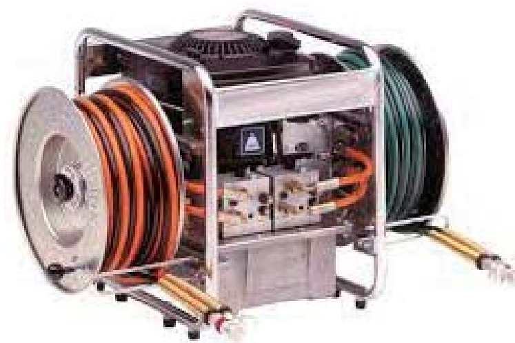
Obr. 4.43 Hydraulická pohonná jednotka (agregát)
