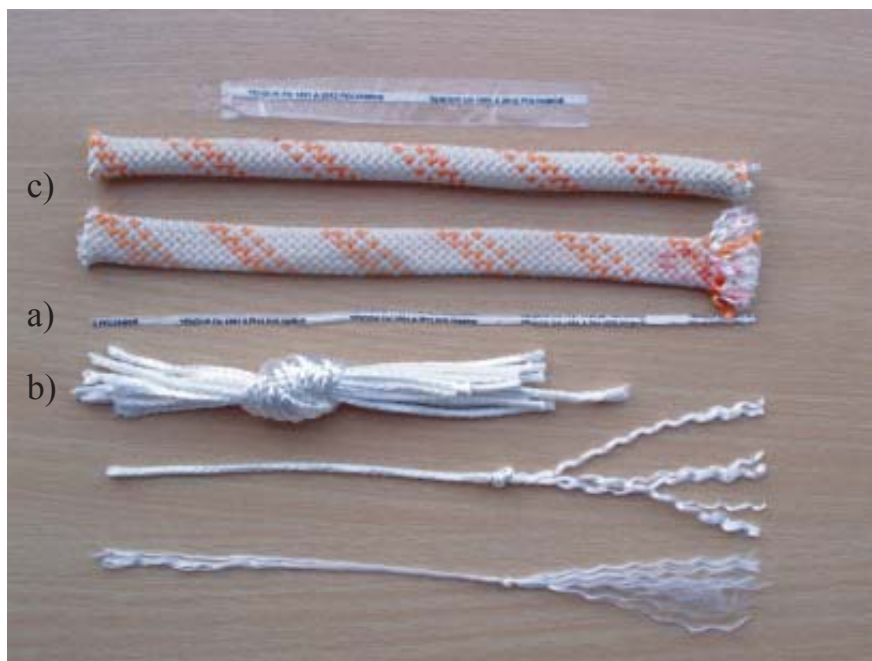
Obr. 5.1 Lana a) kontrolní páska, b) jádro, c) opleť
