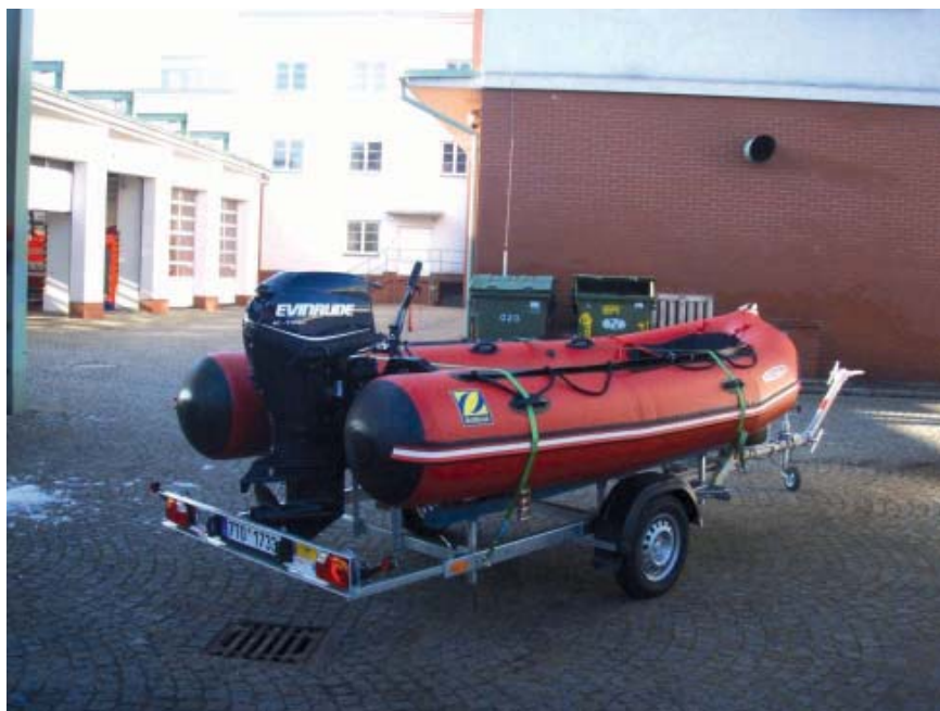
Obr. 6.18 Nafukovací plavidlo s pevnou záďí
