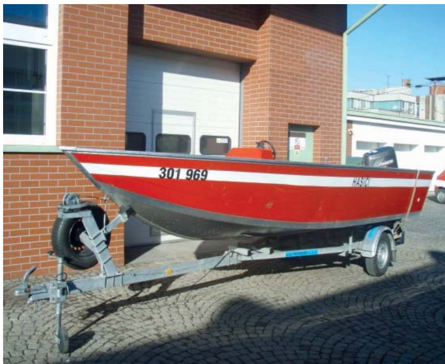
Obr. 6.17 Pevné (hliníkové) plavidlo
