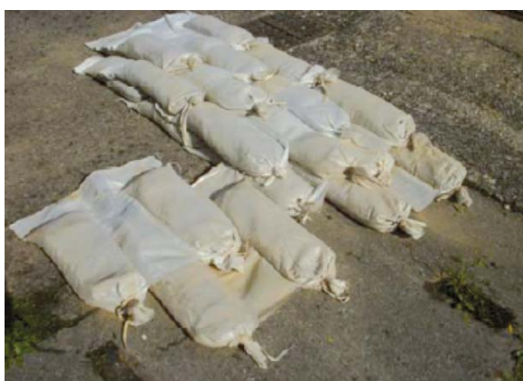
Obr. 4.36 Kladení dvoukomorových pytlů [11]
