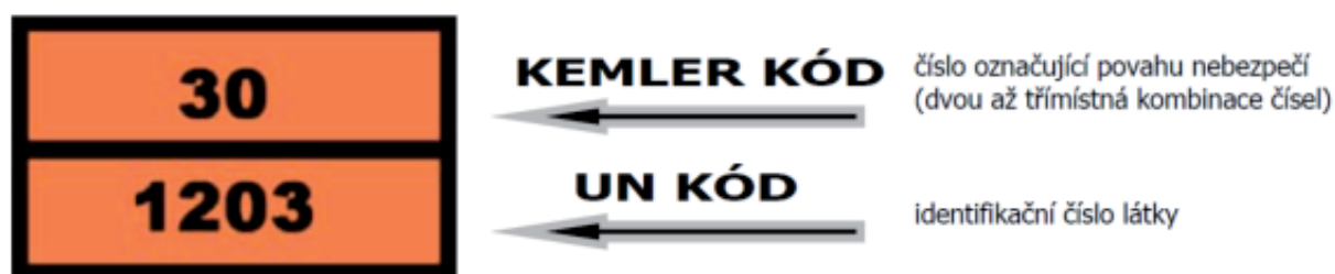
Obr. 4.20 Výstražná tabulka pro označování nebezpečných nákladů - rozměry 400 x 300 mm
